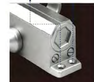
速度调节 (Adjust speed) 顺时针为增大、逆时针为减小
